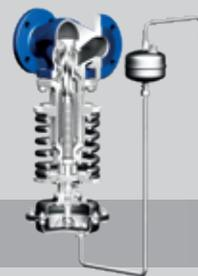
**Régulation sans énergie auxiliaire**
