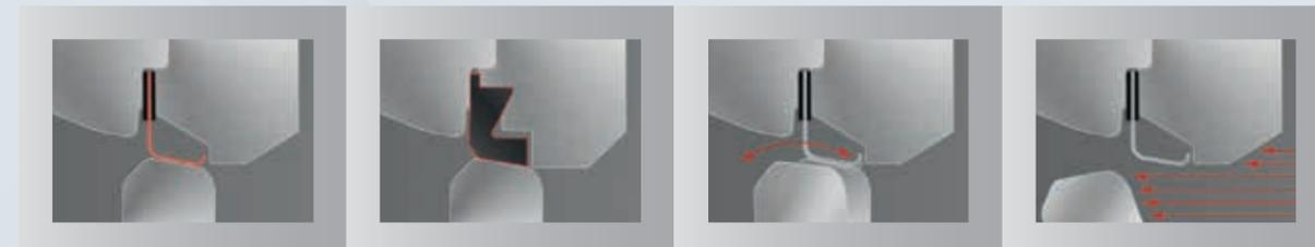
Etanche à la fermeture jusqu'à +260°C , bague d'étanchéité métallique
